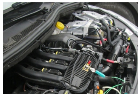
■ Рис.2: Электромагнитные актуаторы e-Lift3, интегрированные в 3-цилиндровый двигатель внутреннего сгорания
