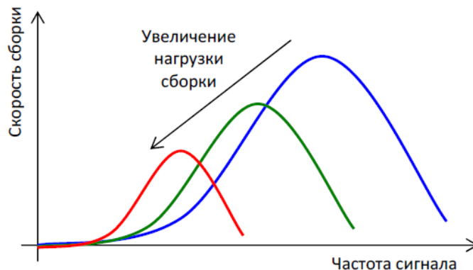
Рисунок 34 Пример воздействия частоты на скорость для нескольких нагрузок
