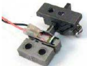
Рисунок 12 Извлеченный двигатель без шкалы магнитного датчика
