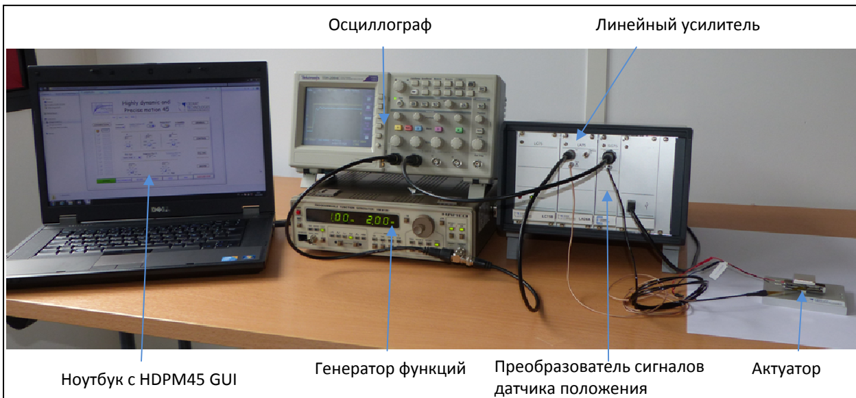
Рисунок 19 Полная настройка управления
