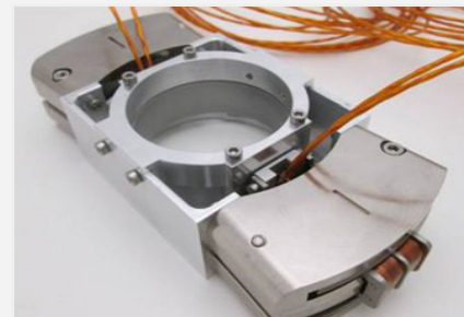
■ Рис.1: Звуковая катушка 1 сканирующего механизма метеоспутника MTG для SENER для применения в космосе
