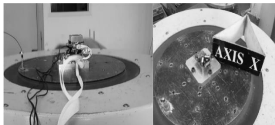
Рис. 2. Испытания на вибростойкость 3-х осевой сборки на пьезодвигателях
