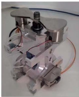
**Рисунок 9.** Испытательный стенд для двигателя RCVM-PP
