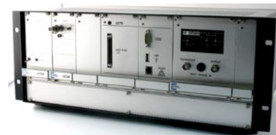
Человеко-машинный интерфейс с программным обеспечением LabView® и корпусом 84F с блоком управления UC75 на основе Compact-RIO.
