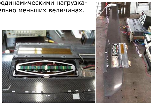
Helicopter Scale-1 лопасть с активным закрылком с применением APA1000XL от CEDRAT TECHNOLOGIES.
