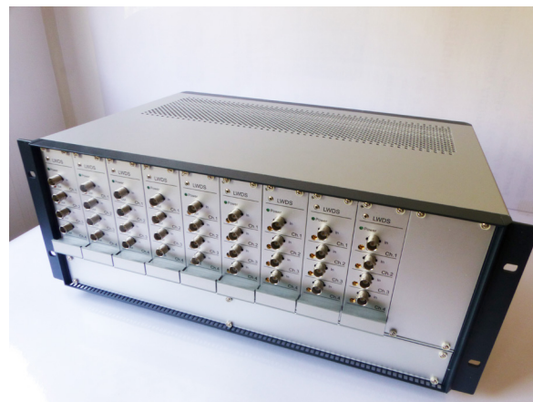
Рис. 5: 36-канальный блок передачи с выходным напряжением \pm 15 В в диапазоне 100-1000 кГц
