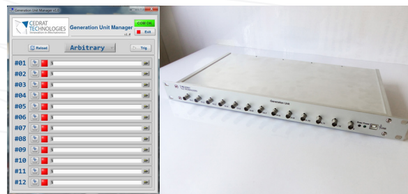
Рис. 7: 12-канальный генератор произвольной формы сигнала с частотой дискретизации 10 MSps, разрешением 14 бит и специализированным графическим интерфейсом для конфигурации.
