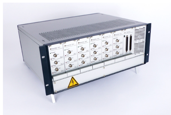
Рис. 6: 18-канальный блок передачи с выходным напряжением \pm 200 В для приложений в диапазоне 25-40 кГц
