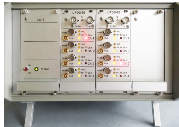
Рис. 1: 8 канальная лабораторная стойка полнофункциональных каналов SHM (источник питания постоянного тока, излучение, прием)
