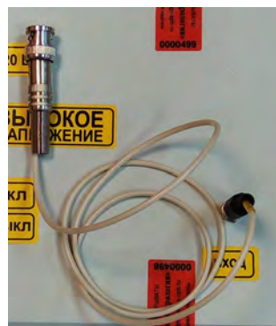
б) Подключение кабеля для подачи входного аналогового сигнала
