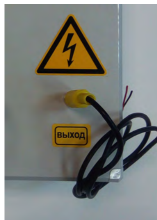
б) Подключение кабеля для подачи управляющего напряжения на пьезоэлектрический актюатор
